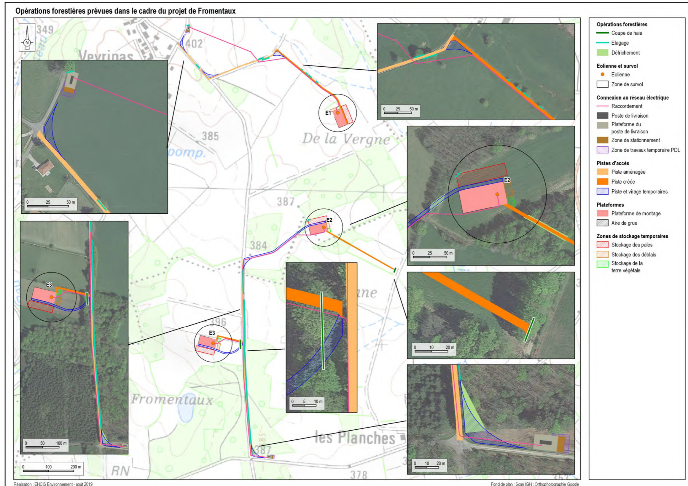
Carte 38 : Opérations forestières prévues dans le cadre du projet éolien de Fromentaux
