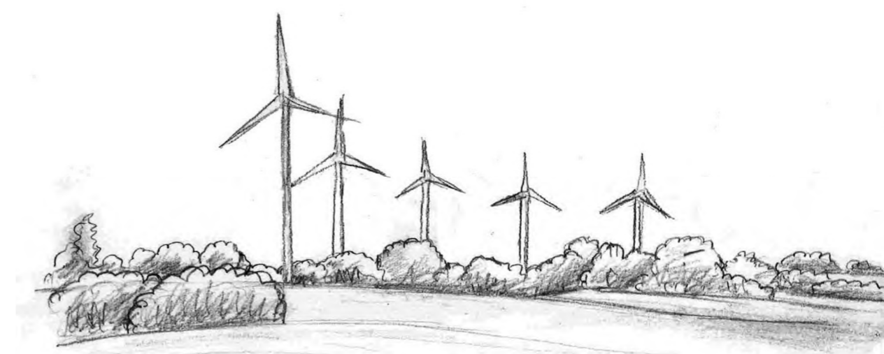
Une implantation selon une courbe permet de donner plus de cohérence à l'ensemble
