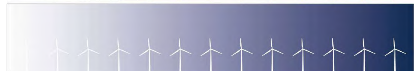
Figure 17 : Simulation d'éclaircement des éoliennes en fonction de la couleur du ciel.
